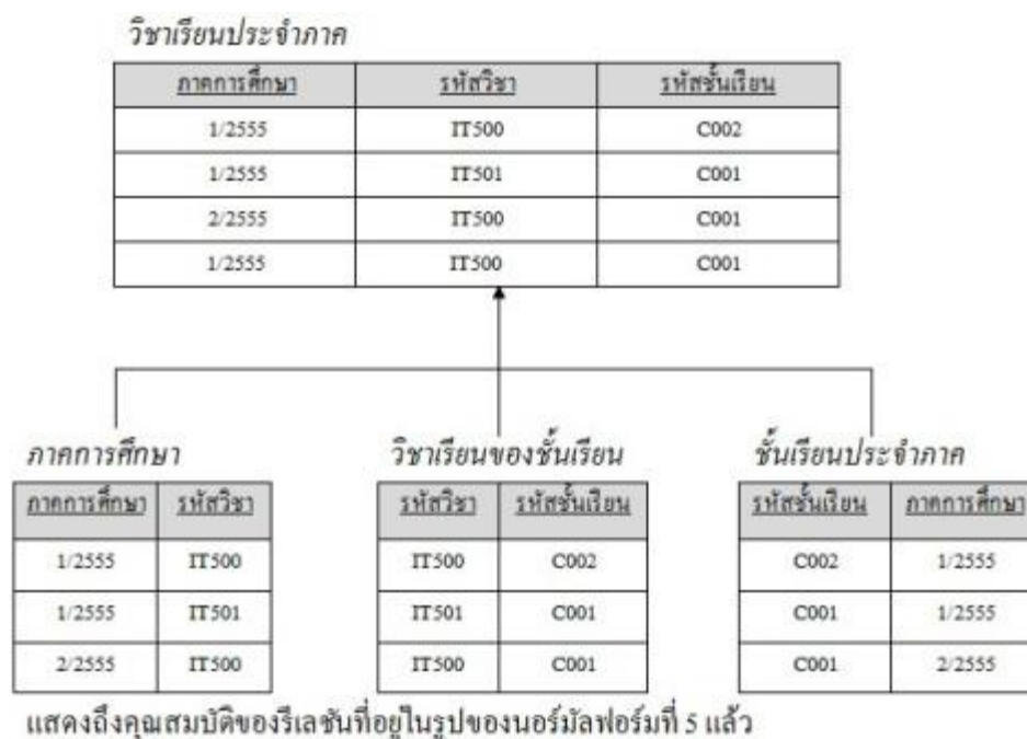
ภาพที่ 2.19 ภาพรีเลชันที่อยู่ในรูปนอร์มัลฟอร์มที่ 5 แล้ว
